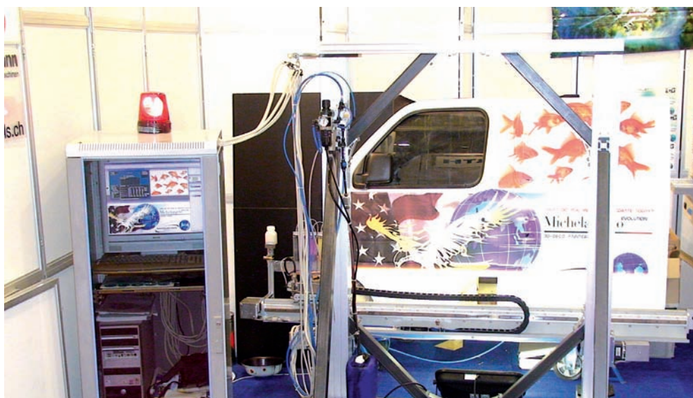
Impression en cours d'un côté de camionnette à l'aide d'une imprimante Michelangelo
