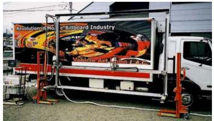
Druck eines 7m LKW's mit einer 4.5 m Maschine
